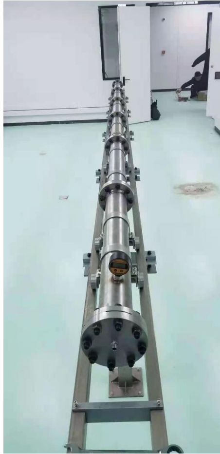
图 2 激波管装置实图（正面）
