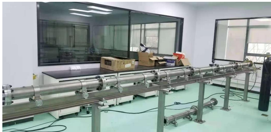
图 3 激波管装置实图（侧面）
